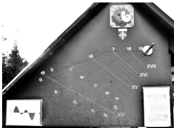
Obr. 16: Svislé hodiny s korekční křivkou (Žlutava, okres Zlín)
