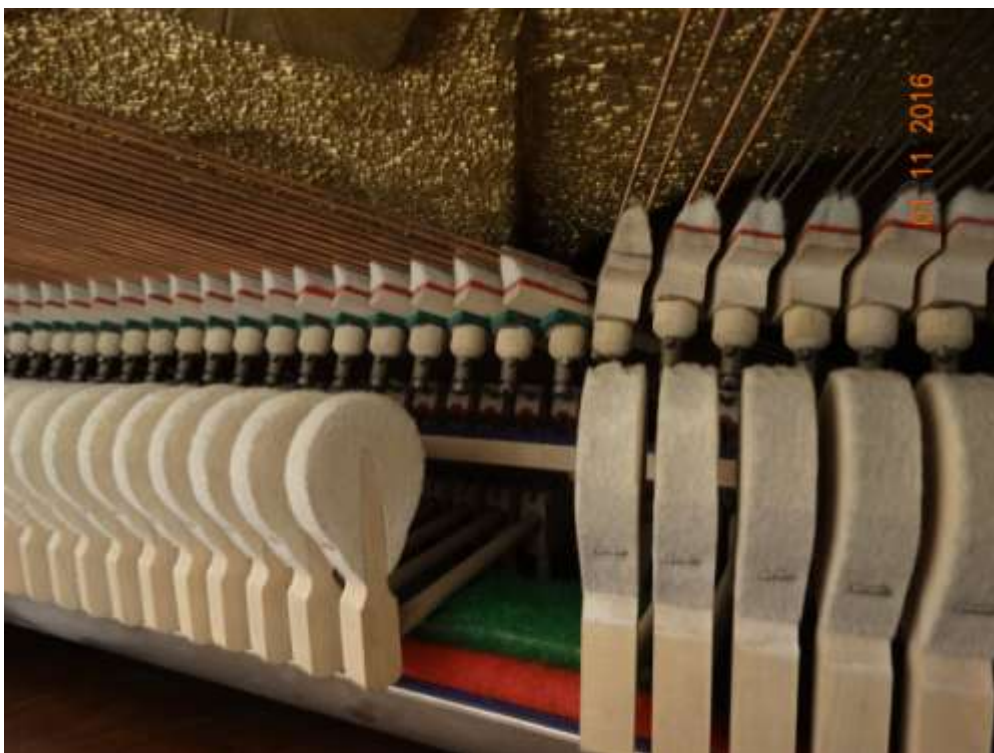
Obrázek 13: Pohled na kladívka, tlumítka a struny bez sešlápnutého pedálu
