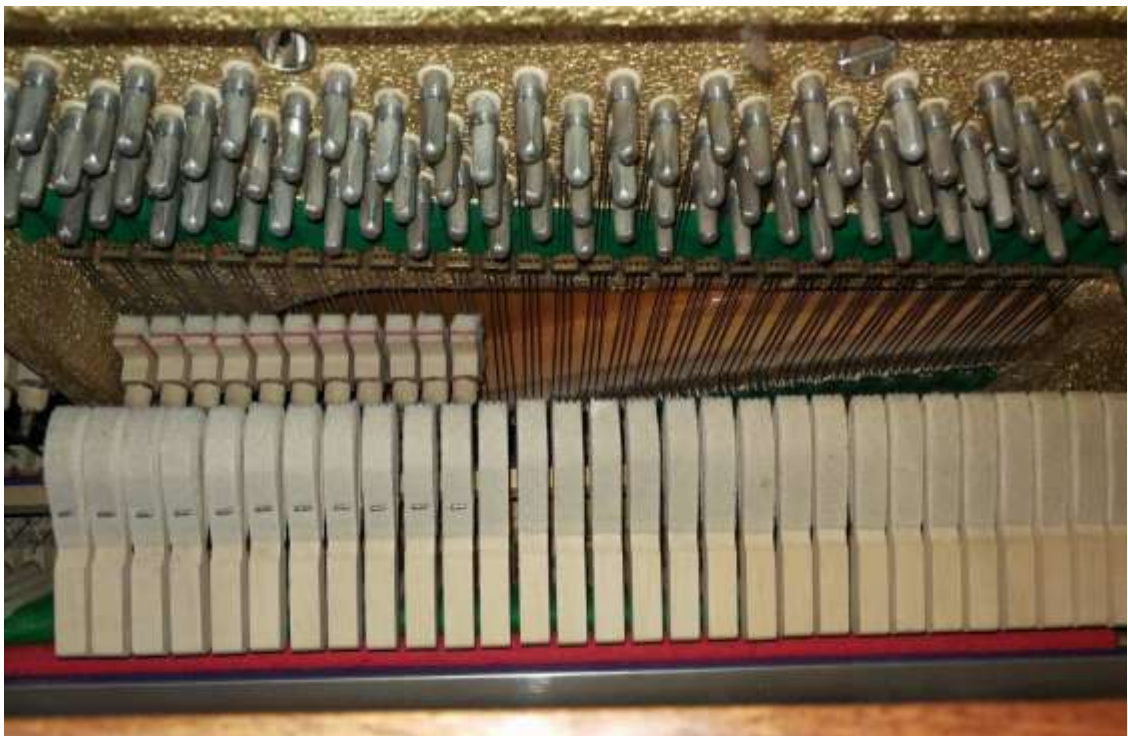
Obrázek 12: Pohled na struny, u kterých nejsou tlumítka
