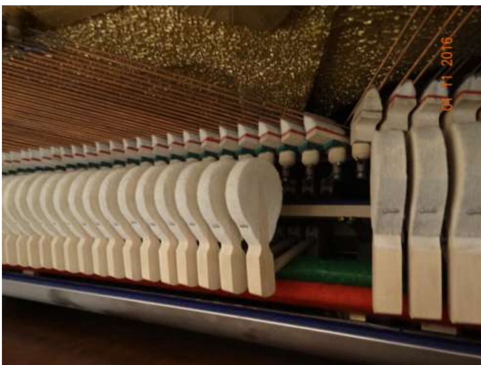
Obrázek 18: Pohled na kladívka, tlumítka a struny se sešlápnutým levým pedálem
