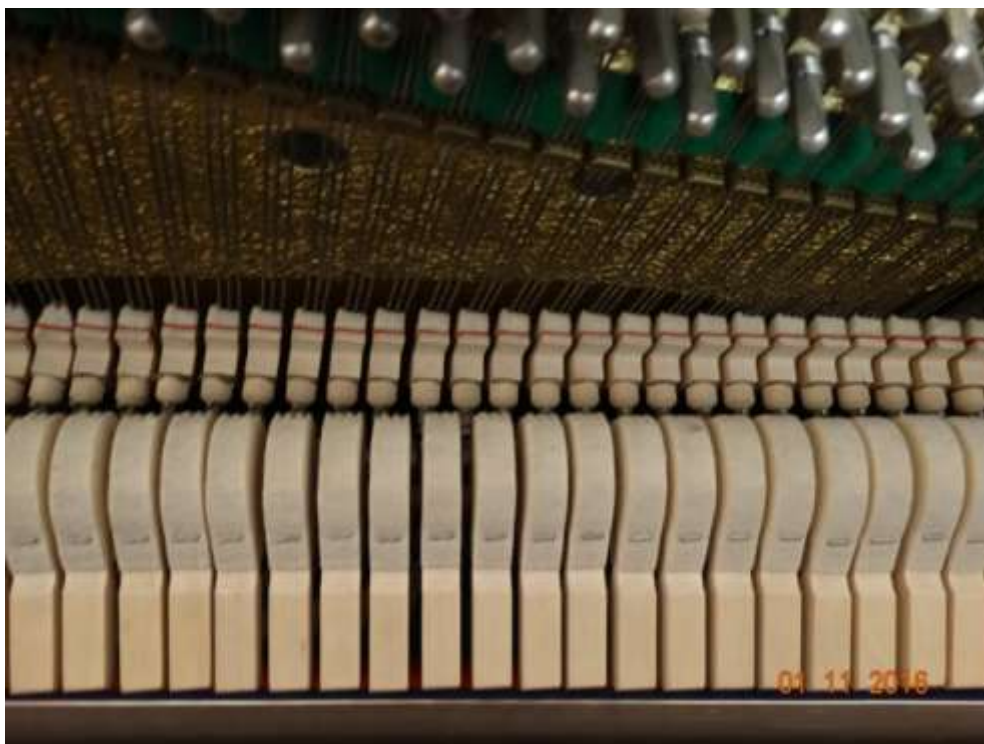
Obrázek 15: Pohled na kladívka, tlumítka a struny bez sešlápnutého pedálu
