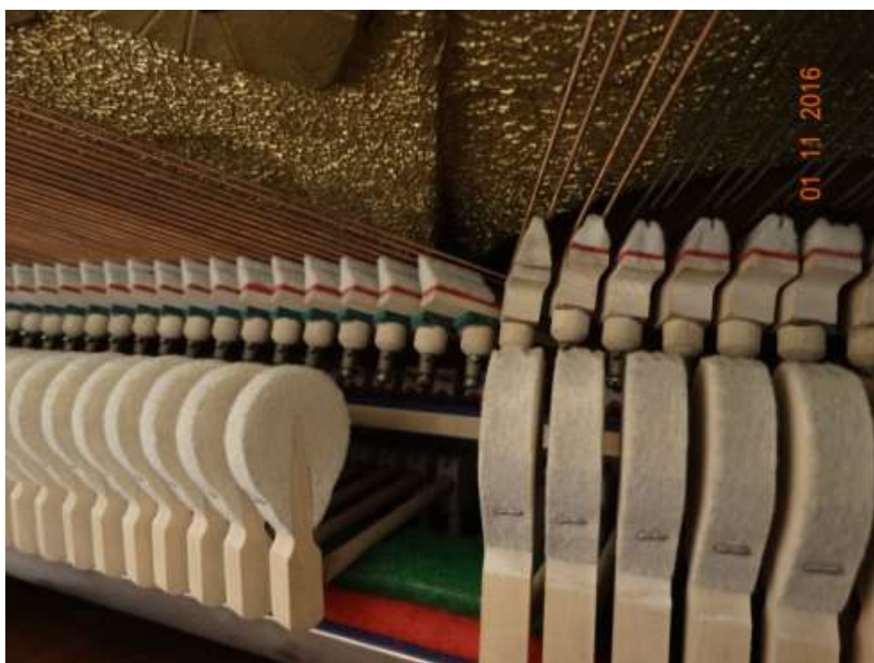
Obrázek 14: Pohled na kladívka, tlumítka a struny se sešlápnutým pravým pedálem
