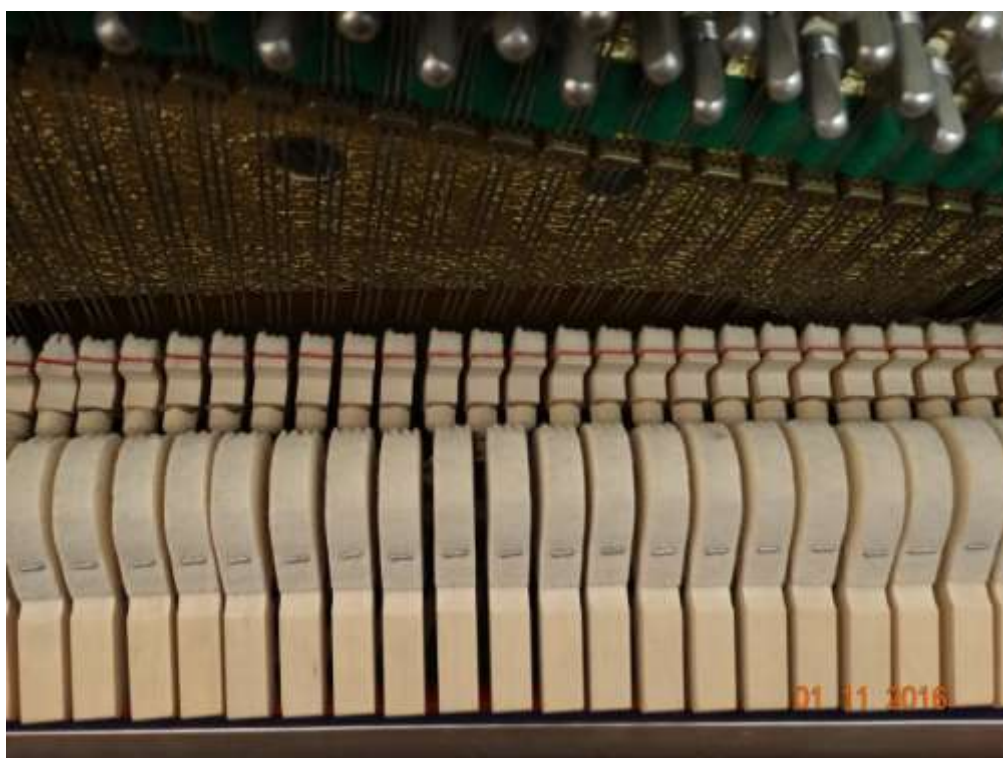
Obrázek 16: Pohled na kladívka, tlumítka a struny se sešlápnutým pravým pedálem
