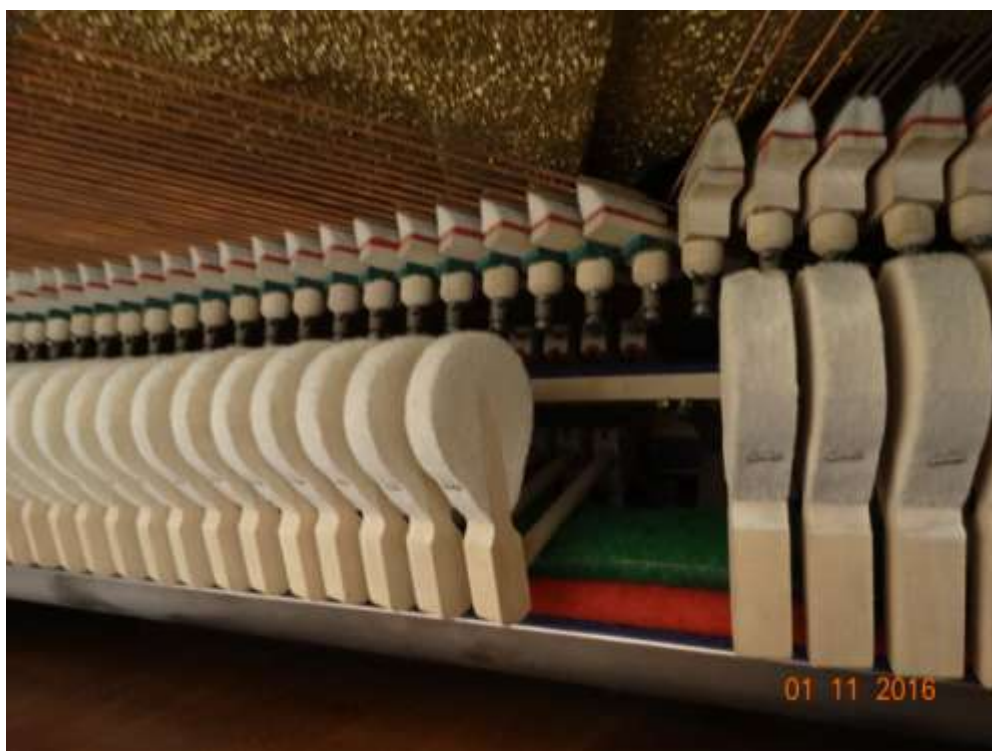
Obrázek 17: Pohled na kladívka, tlumítka a struny bez sešlápnutého pedálu
