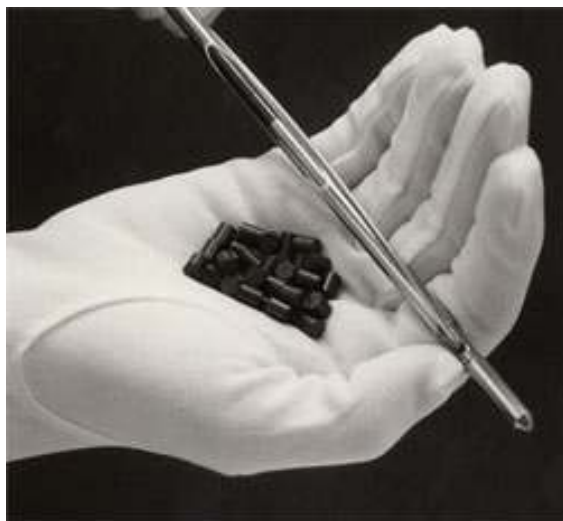
Peletky \text{UO}_2 – jaderné palivo [2]
