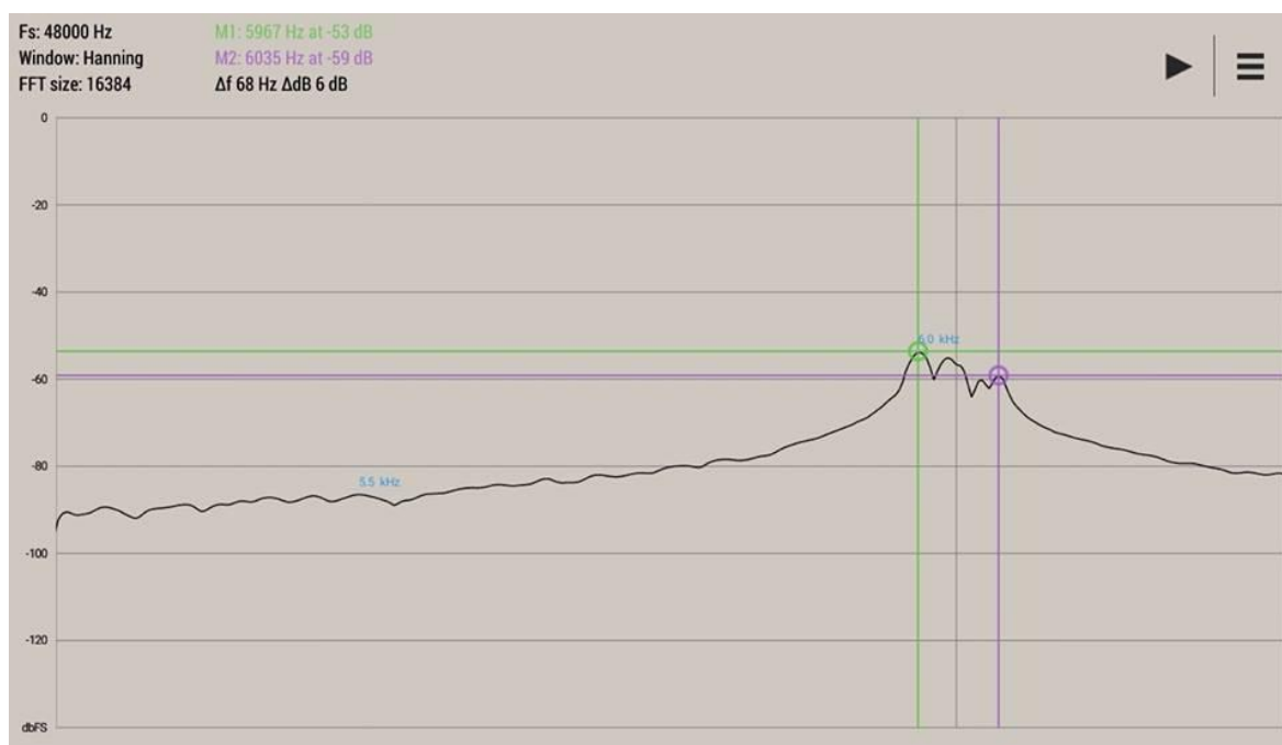
Obrázek 74: Měření frekvence aplikací Advanced Spectrum Analyzer, zapnutý je druhý reproduktor
