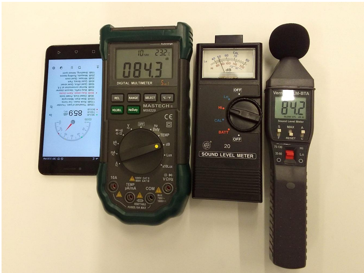
Obrázek 50: Měření hladiny intenzity zvuku růžového šumu několika hlukoměry
