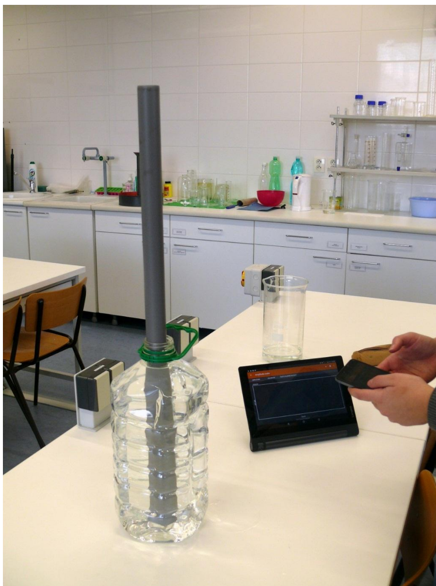
Obrázek 32: Měření rychlosti zvuku ve vzduchu pomocí plastové trubice a barelu
