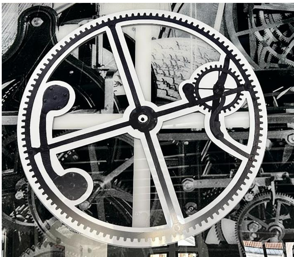
Obrázek 27: Ozubené kolo ke kalendářnímu číselníku
