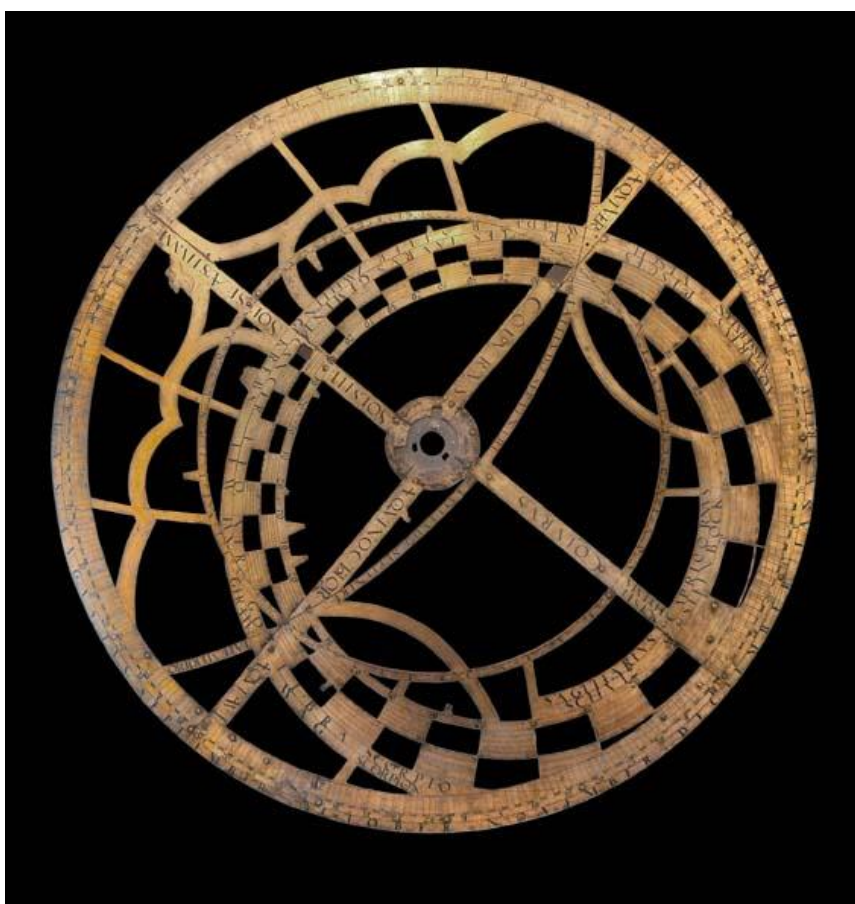
Obrázek 8: Síť Fabriciova astrolábu (převzato z [5])
